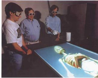
Este es un entorno de interacción ampliamente utilizado en Realidad Virtual. El sistema consiste en una mesa situada en posición horizontal o inclinada, sobre la superficie de esta se proyecta generalmente mediante retro-proyección la señal de video que proviene del computador.
